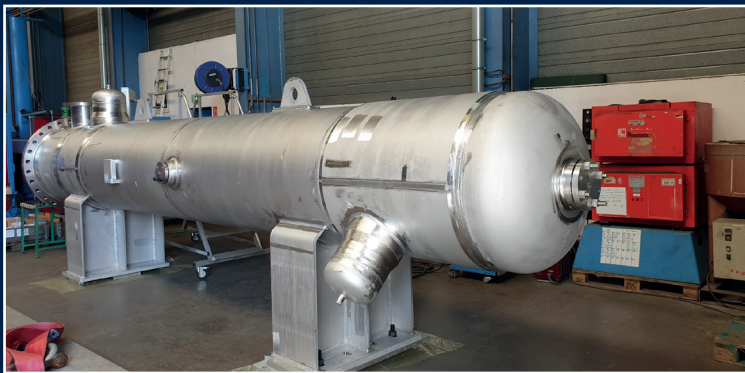
◀ ECHANGEUR EASU, ESPN DE NIVEAU 2, CONCU SELON LE CODE RCC-M © ONET TECHNOLOGIES
