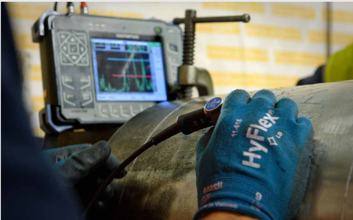
EXAMEN PAR ULTRASONS DE SOUDURES
